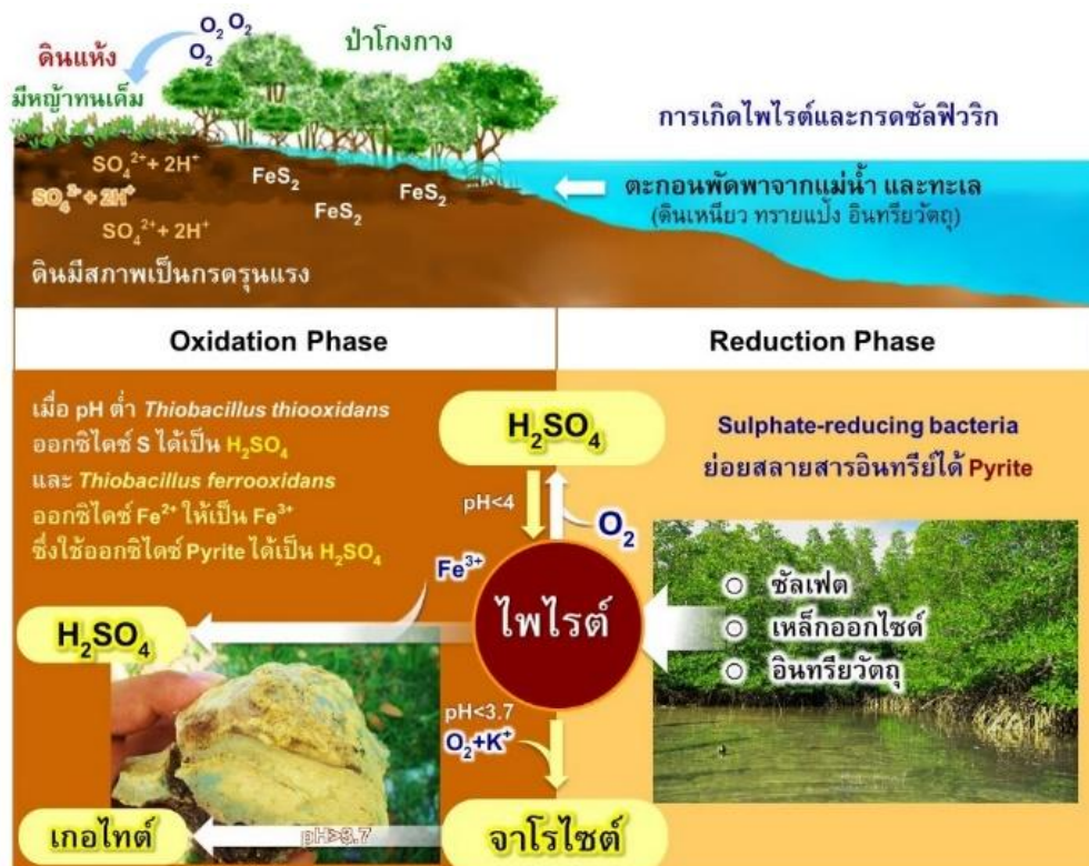
ภาพที่ 9 กระบวนการเกิดไฟไรต์และกรดกำมะถันในดินเปรี้ยวจัด ที่มา : จำเป็น (2562)
